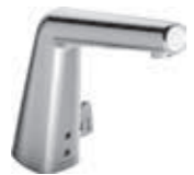
HANSADESIGNO Elektronická batéria pre umývadlo, DN 15 sieťová prevádzka 5179 2221 chróm 3S-inštalácia Riadená bezdotykovo elektricky (infračervený lúč), vrát. sieťového napájča a prívodného kábla, odpadová súprava s push ovládaním, pripojenie pomocou tlakových hadíc vyloženie: 138 mm
