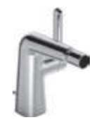
HANSADESIGNO Jednootvorová páková batéria, DN 15 5198 3283 chróm pre bidet, odpadová súprava (kov), pripojenie pomocou tlakových hadíc vyloženie: 119 mm
