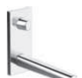
HANSADESIGNO Súprava na konečnú montáž, umývadlová elektronická batéria na inštaláciu do steny, DN 15 (G 1/2) hodiace sa k HANSAMATRIX 4492 2010* chróm s termostatickým tepelným zmiešavaním, riadená bezdotykovo elektricky (infračervený lúč), vrát. sieťového napájča a prívodného kábla vyloženie: 195 mm
