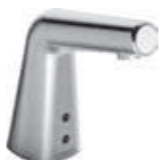
HANSADESIGNO Elektronická batéria pre umývadlo, DN 15 sieťová prevádzka 5193 2211 chróm 3S-inštalácia vrát. sieťového napájča a prívodného kábla, MIKADO® regulátor prúdu vody, bez odpadovej súpravy, hygienické preplachovanie po 72 hodinách na 30 sekúnd nastavené z výroby vyloženie: 100 mm
